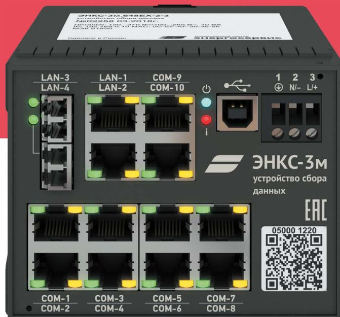
Устройства сбора данных (УСД) ЭНКМ-3 и ЭНКС-3м предназначены для сбора и передачи данных в автоматизированных системах управления объектов энергетики и промышленности. УСД выступают в роли информационных шлюзов, обеспечивающих контроль и оптимизацию процесса передачи во внешние системы разнородной технологической информации от устройств и систем, установленных на объекте.
